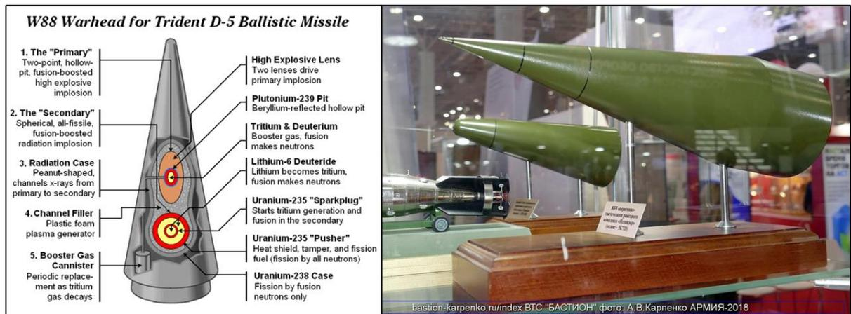
Figura 2. A la izquierda, esquema del funcionamiento de una cabeza de guerra estratégica W88 de dos etapas (la 1.<sup>a</sup> etapa de fisión suministra la energía que provoca la detonación de la 2.<sup>a</sup> etapa de fusión). A la derecha, cabeza de guerra 9H70 para misiles Iskander-M. Se aprecian las similitudes entre ambas, pese a ser la segunda una TNW.
